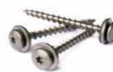
Skrue m. skive 4,8 x 50 mm, TX-20, fibercut, kvalitet A4
